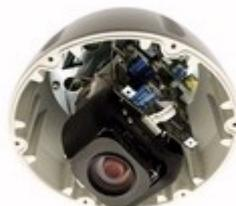
La cupola della dome fa passare i raggi infrarossi, quindi se capita di non poter vedere all'interno perché risulta essere nera è possibile usare una videocamera con visione notturna per ispezionare l'interno della dome e scoprire dove sta guardando. Solitamente le telecamere di tipo dome seguono dei percorsi predefiniti, tuttavia in alcuni casi sono comandate a distanza.
